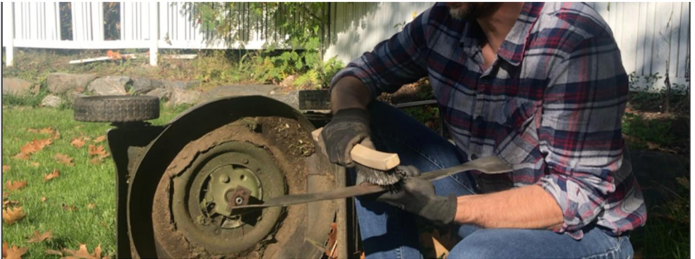
Si vous utilisez une lime, placez votre lame dans un étau pour la fixer solidement. Pour le touret, il est préférable d'utiliser des gants et des lunettes de sécurité. On doit passer la lime de l'intérieur vers l'extérieur tout en suivant l'angle de coupe qui est généralement aux alentours de 45 degrés. Mais il peut varier selon le modèle; pour en être certain, référez-vous au manuel du fabricant.
